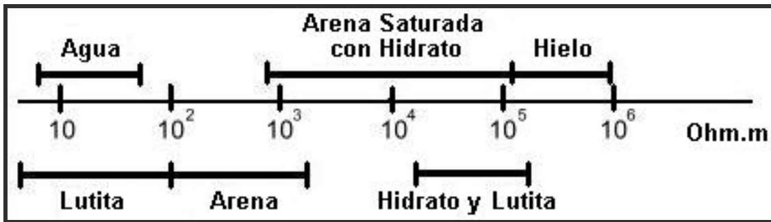
Figura 6. Rango de resistencia eléctrica de los hidratos, arena y lutita.
